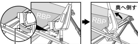
この溝とフレームのクロスしている上側を合せる。
