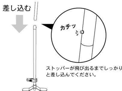
**3** 上部横棒ジョイントを縦棒に取り付け下部横棒ジョイントの向きを合わせて固定する。
